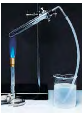
ნახ. 1.46. მალაქიტის დაშლა. სინჯარაში მიღებული შავი ფერის ფხვნილი სპილენძ(II)-ის ოქსიდია. სინჯარის კედლებზე შეინიშნება წყლის წვეთები. რეაქციის შედეგად ნახშირორჟანგის გამოყოფას ადასტურებს ჭიქაში მოთავსებული კირიანი წყლის ამღვრევა.
