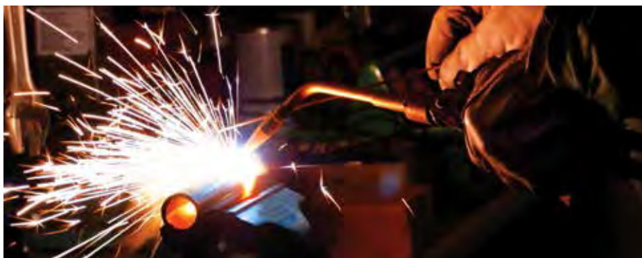
ნახ. 2.13. ჟანგბადის არეში აცეტილენის წვა მაღალ ტემპერატურას იძლევა, რაც ავტოგენური შედუღებისას გამოიყენება.
