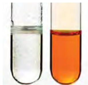
ნახ. 2.11. ბრომის ტესტი: ნაჯერმა ნახშირწყალბადმა ხსნარს ფერი არ შეუცვალა (მარჯვნივ), ხოლო უჯერი ნახშირწყალბადის შემცველ სინჯარაში დამატებული ბრომიანი ხსნარი გაუფერულდა (მარცხნივ).
