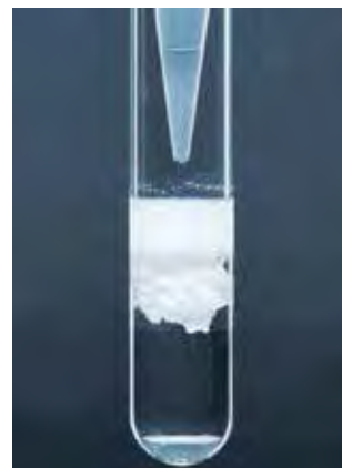
ნახ. 1.28. მარილმჟავასა და ვერცხლ(I)-ის ნიტრატის ხსნარების შერევის შედეგად ხაჭოსებრი თეთრი ნალექი მიიღება.
