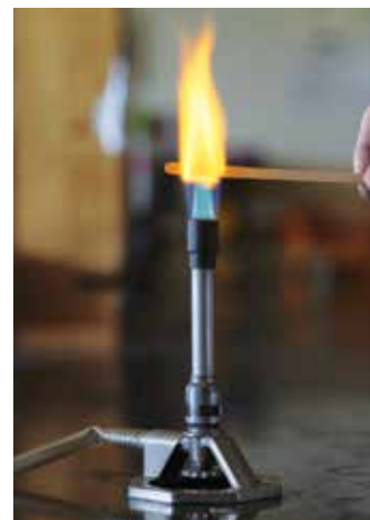
ნახ. 3.8. ნატრიუმის ქლორიდის ხსნარში დასველებულ წკირს თუ შევიტანთ ალში, ის კაშკაშა ყვითელ ფერს მიიღებს.
