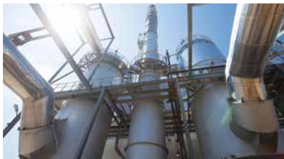
ნახ. 3.42. გოგირდის ტრიოქსიდის მიღება გოგირდმჟავას წარმოების ერთ-ერთი საფეხურია და ის სპეციალურ დანადგარში მიმდინარეობს, რომელსაც „კონტაქტურ აპარატსაც“ უწოდებენ.
