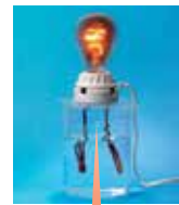
ნახ. 1.20. ძლიერი ელექტროლიტი წყალში გახსნისას მთლიანად დისოცირდება.
