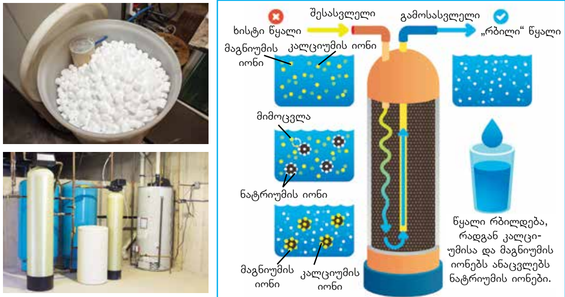
ნახ. 3.27. წყლის დამარბილებელი მოწყობილობა, რომელშიც მოთავსებულია იონიტი.
