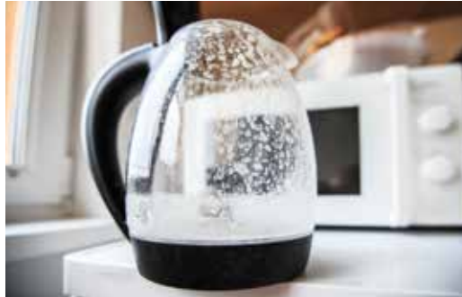
ნახ. 3.26. მინადული ჩაიდნის კედლებზე.
