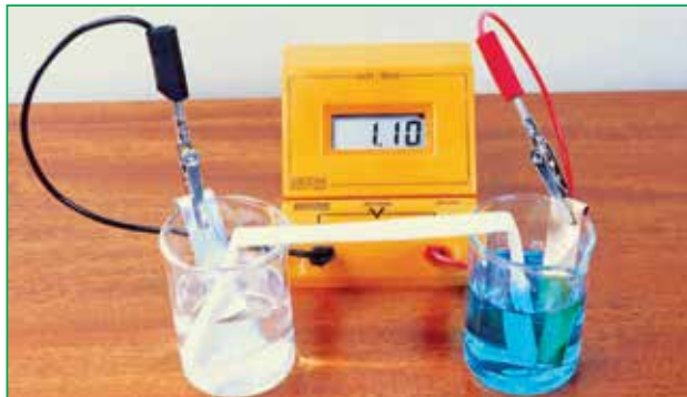
ნახ. 2.11. მოცემული გალვანურ ელემენტში წარმოქმნილი დაზვერვა 1.1 ვოლტია.
