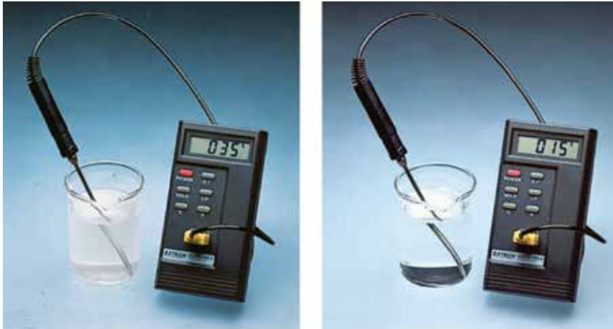
ნახ. 1.8. (ა) \text{CaCl}_2 -ის წყალში გახსნა ეგზოთერმული პროცესია, ამიტომ ელექტრონული თერმომეტრის ჩვენება იზრდება საწყისი 25^{\circ}\text{C} -დან 35^{\circ}\text{C} -მდე; (ბ) \text{NH}_4\text{NO}_3 -ის წყალში გახსნა ენდოთერმული პროცესია, ამიტომ ელექტრონული თერმომეტრის ჩვენება მცირდება საწყისი 25^{\circ}\text{C} -დან 15^{\circ}\text{C} -მდე.
